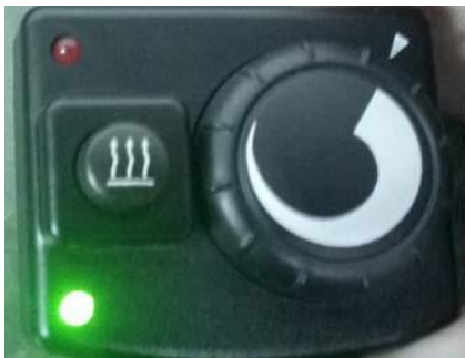
Рис. 2: Индикатор источника питания (LED, зеленого цвета)
