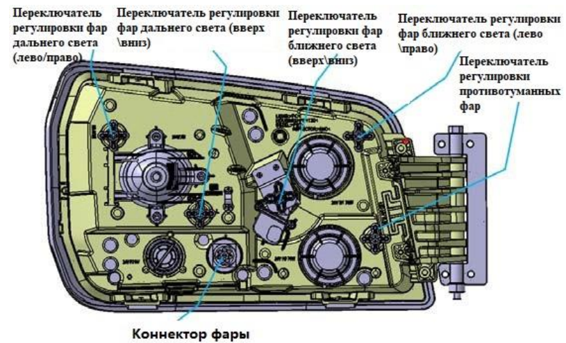
Рис. 3 Компоновка переключателей регулировки блока передних фар
